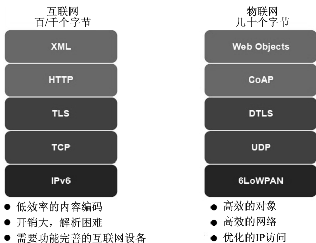
图3 互联网和物联网协议比较
