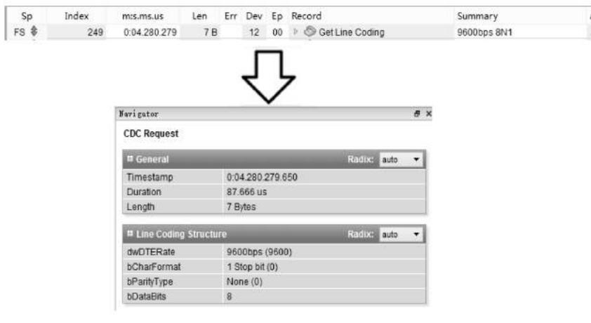
图 5-24 GetLineCoding 请求
