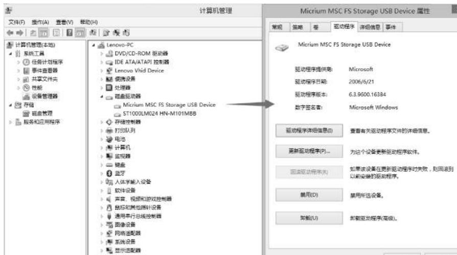
图 7-10 设备管理器显示新安装的设备
