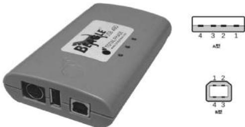
图 2-6 Beagle USB 480 协议分析仪:捕捉端
