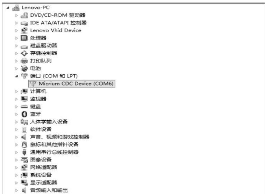
图 5-14 设备管理器显示新安装的设备
